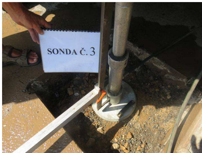
Sonda č.3 konstrukční vrstva –zatěžovací zkouška
